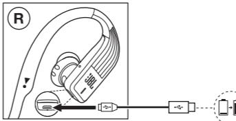
充電中は、電源 / Bluetooth インジケーターが赤く点灯し、充電が完了するとインジケーターが消灯します。充電が完了したら充電用ケーブルを外してください。
