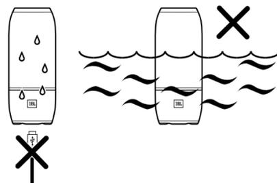
本製品は、防水規格IPX7相当の仕様となっています。一時的に一定水圧の条件に水没しても内部に浸水することがない「防浸形」です。
