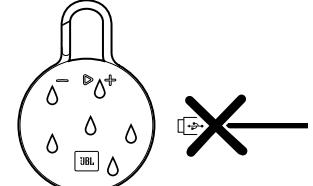
本製品は、防水規格IPX7相当の仕様となっています。一時的(30分)に一定水深(1m)の条件に水没しても内部に浸水しない「防浸形」です。
